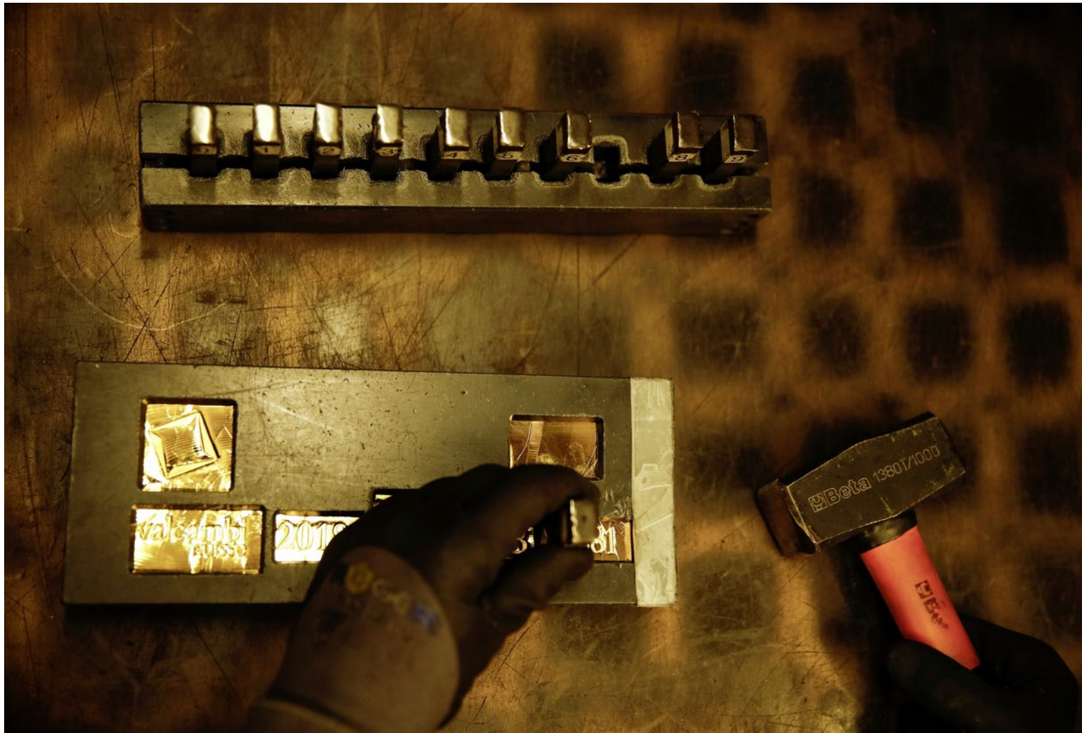
Am Ende der Verarbeitung: Auf dem 12,5 Kilogramm schweren Goldbarren wird die Prägung angebracht.
